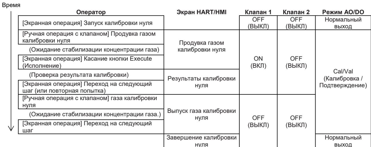
Рисунок 9.14 Клапаны и Выходы AO/DO для калибровки нуля
