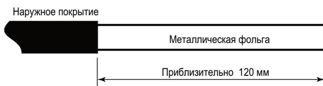
**Снятие наружного покрытия**
