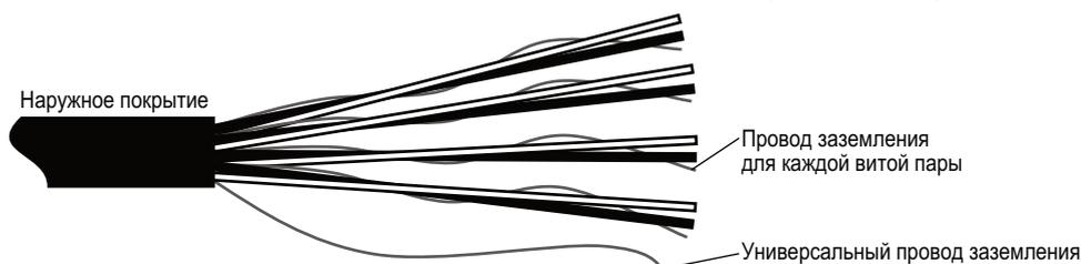
**Снятие металлической фольги экрана с каждой витой пары и оранжевого провода**
