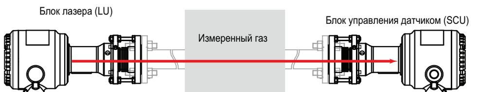
(a) При законченной регулировке оптической оси (правильное положение оптической оси)
