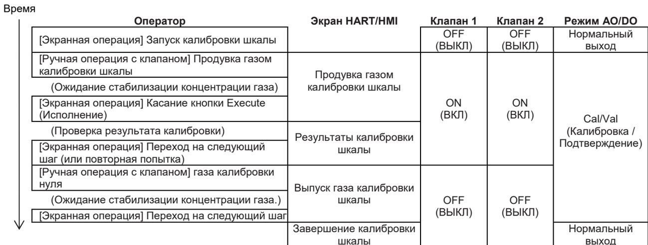
Рисунок 9.15 Клапаны и Выходы AO/DO для калибровки шкалы
