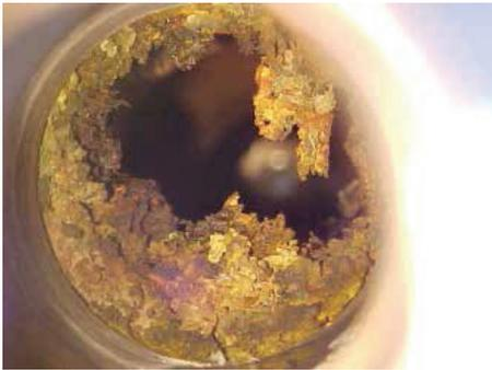
**Рисунок 10.2 Пример осадков внутри отверстий**
