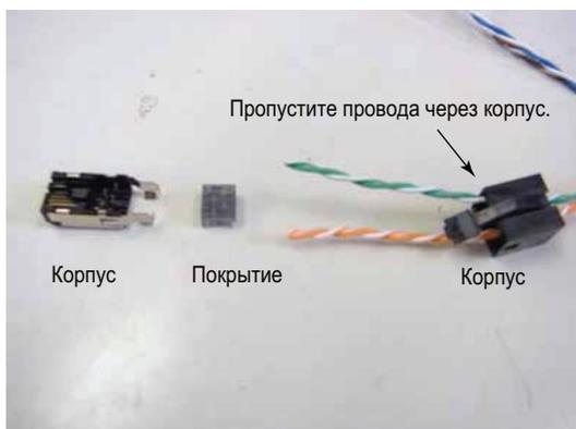
**Пропуск проводов через корпус коммуникационного разъема**
